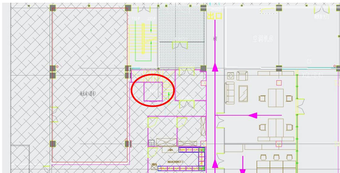
注：平台安装净空为 1850\*1500，安装于 DIY 生产线纯水站西侧。
